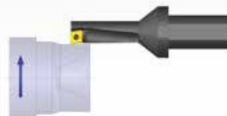
Drehen von Außenkonturen (Wechsel der Drehrichtung beachten)
